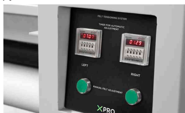
Автоматическая система центрирования фетровой ленты
