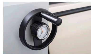
Регулировка натяжения фетра с помощью манометра
