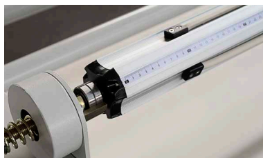
Миллиметровая шкала на валу для правильного расположения рулонов
